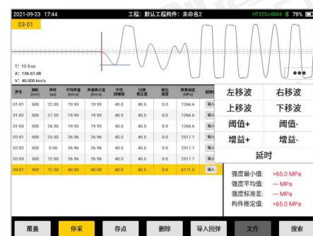
图 3.7 b 测强、测缺、测缝调整菜单栏
