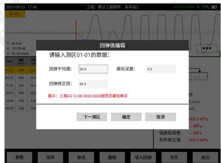
图 5.7 回弹数据修改对话框
