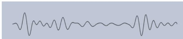
上图为采集到的弹性波及反射信号的时域模型。
