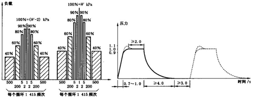
图 A.1 加压过程和压力脉冲示意图
