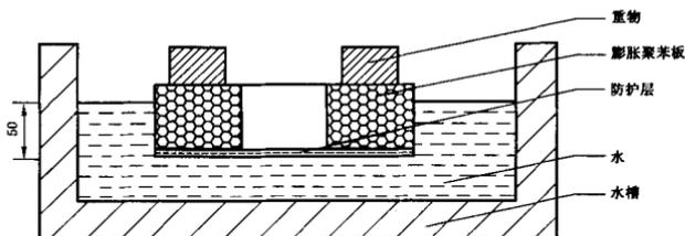
图 B.1 不透水性试验示意图
